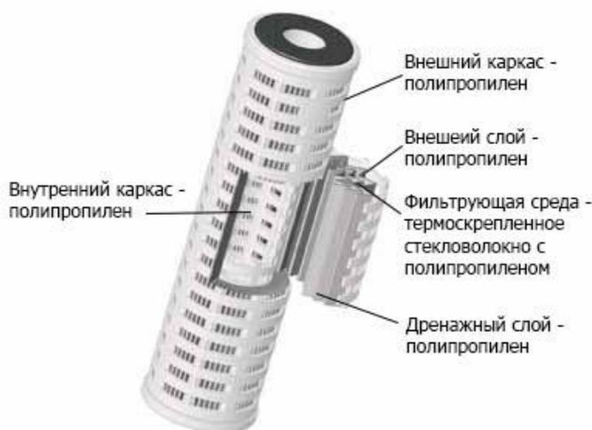
Фильтровальный материал вместе с внешним и внутренним дренажными слоями, выполненными из нетканого термоскрепленного полипропилена, уложен в виде полого цилиндрического гофр пакета высотой 250 мм и помещен между внешним и внутренним перфорированными каркасами.
