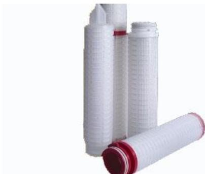
Гофрированные мембранные фильтрующие элементы ЭКОПОР-F-G на основе мембраны из политетрафторэтилена предназначены для удаления бактерий и других частиц размером более 0,2 мкм из газообразных сред при температурах от -5 до 100°C. Преимущественно используются для фильтрации сжатых газов, в том числе агрессивных, а также в качестве дыхательных фильтров на емкостях в различных отраслях промышленности.
