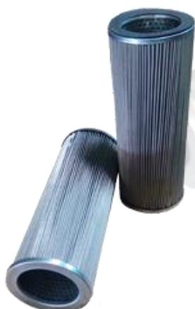
Сетчатые фильтроэлементы ФЭЛ-НС... изготовлены на основе сетки из нержавеющей стали с концевыми деталями из оцинкованной или нержавеющей стали. Швы выполнены с применением эпоксидной смолы.
