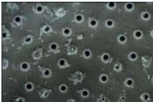
Фото 6. Поверхность отдельной диатомы, обычный кизельгур
