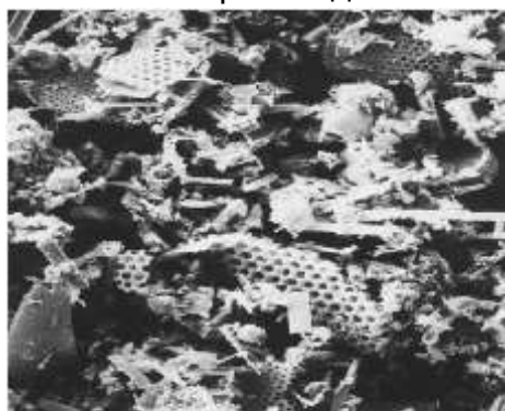
Фото 1 – Диатомит (увеличение на электронном микроскопе).
